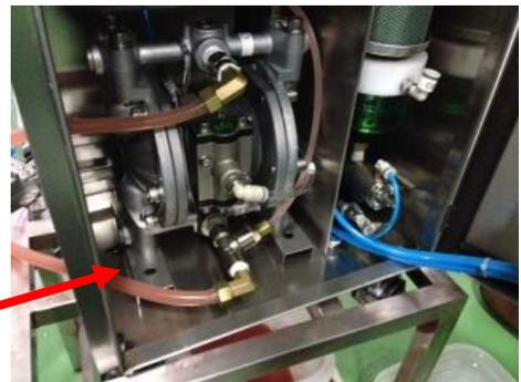
2か所を手で外したら、手でポンプをスライドさせればポンプを簡単に取り外せる。
